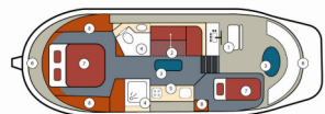
Grundriss River Boat 1122 S ① Steuer mit Sitz ② Sicherheitsausrüstung ③ Tisch ④ WC & Dusche ⑤ KÜchenzeile ⑥ Bade & Sonnen-Terrassen ⑦ Betten ⑧ Sanitäre
